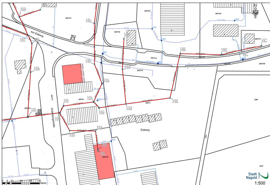
Abb. 03/a Öffentliche Wasserversorgungsleitungen (blau) und Entwässerungskanäle (rot)
